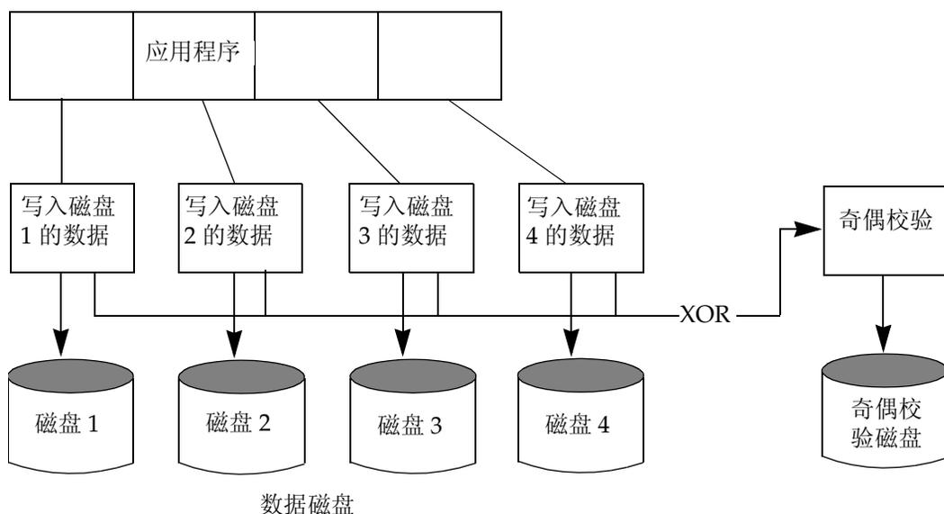
奇偶校验磁盘模型比镜像使用的磁盘空间少，镜像的原始数据及其副本使用等量的存储空间。
