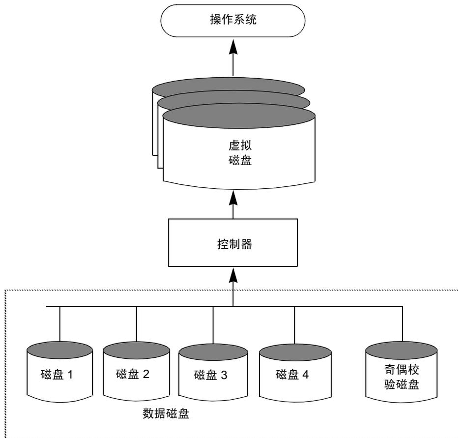
用户数据在所有数据磁盘上条带化。奇偶校验磁盘上的每个条带都包含对数据磁盘的数据进行异或 (XOR) 的结果。如果由于硬件或软件故障导致无法存取某个磁盘上的数据，可以通过奇偶校验磁盘对其余数据磁盘上的数据执行异或 (XOR) 过程来恢复数据。故障磁盘上的数据可以通过 XOR 进程的输出重建。
