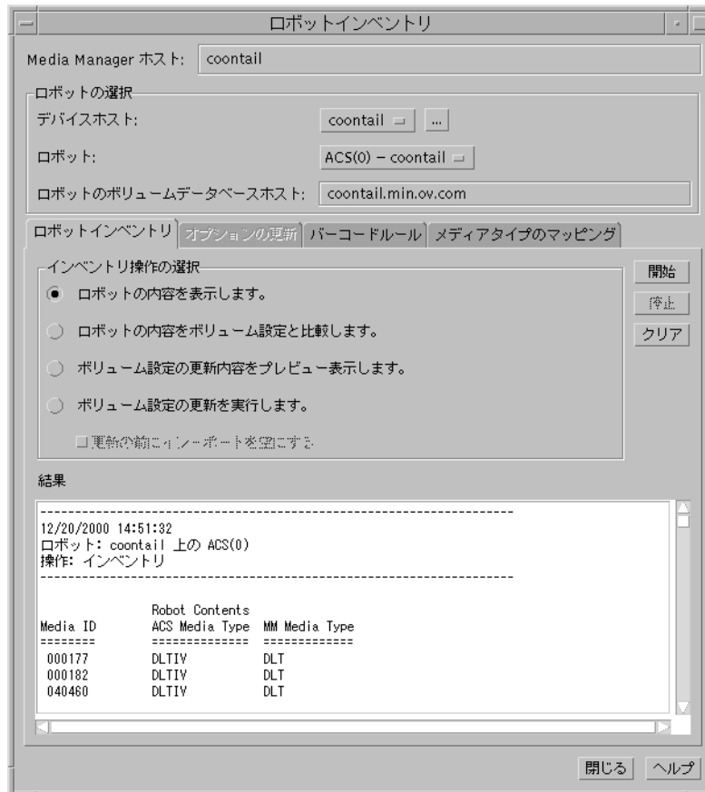
図 7. ロボット インベントリ - 内容レポートの表示 (ACS ロボット)
