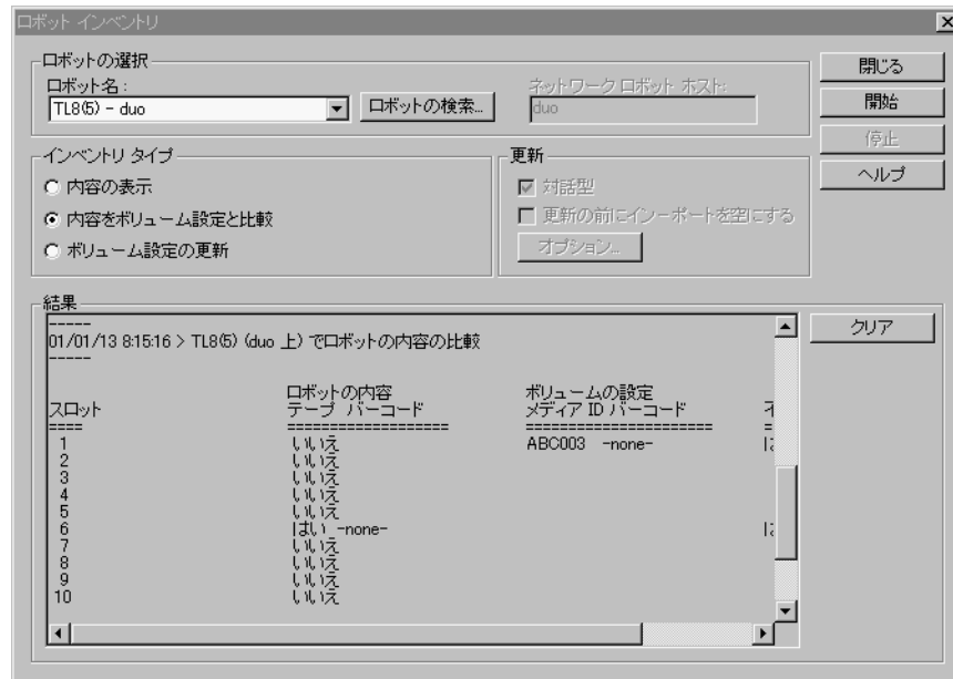
図 4. ロボット インベントリ - 内容レポートの比較 (バーコード判読可能な非API ロボット)
