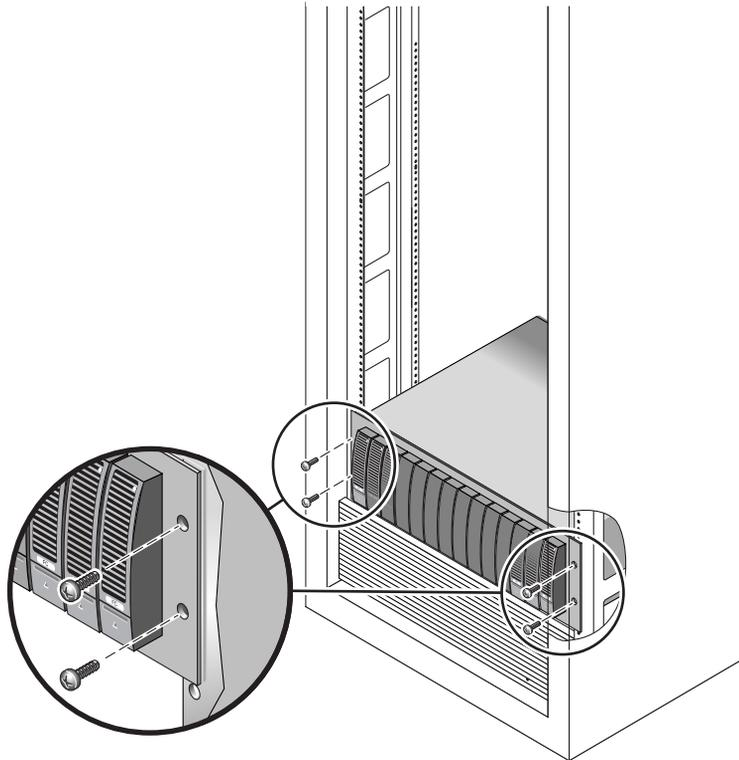
**FIGURE 2-16** Fixation de la baie à l'avant d'un coffret Sun StorEdge Expansion ou Sun Fire
