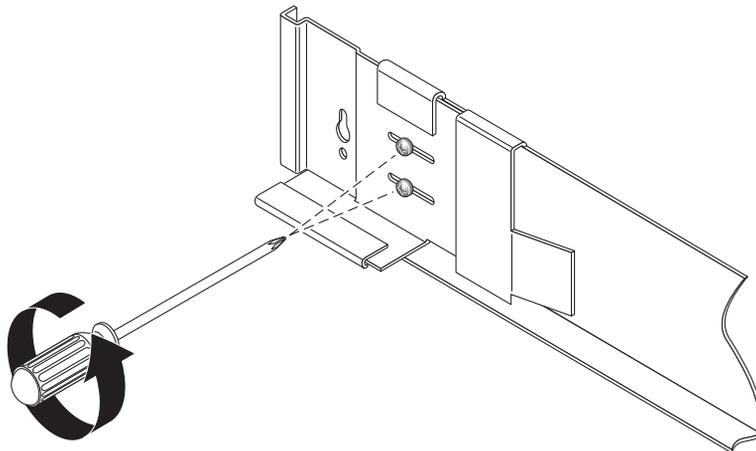
FIGURE 2-1 Desserrage des vis des rails pour régler la longueur des rails
