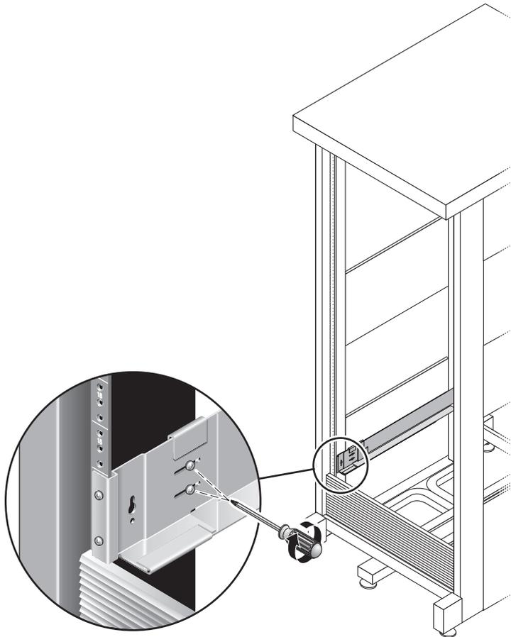
FIGURE 2-12 Serrage des vis de réglage
