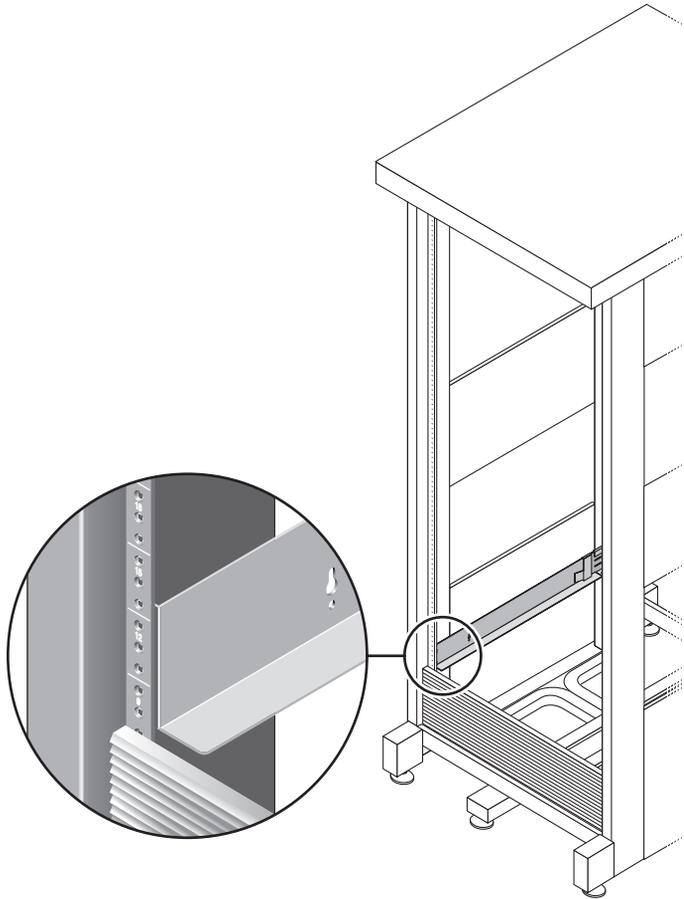
**FIGURE 2-8** Aligned du gauche avec les repères RU (Rack Unit) sur le devant du coffret Sun Rack
