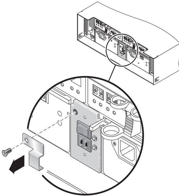
**FIGURE 3-3** Accès au commutateur de débit de liaison
