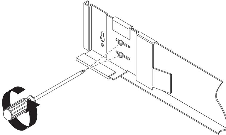
FIGURE 2-7 Desserrage des vis des rails pour régler la longueur des rails
