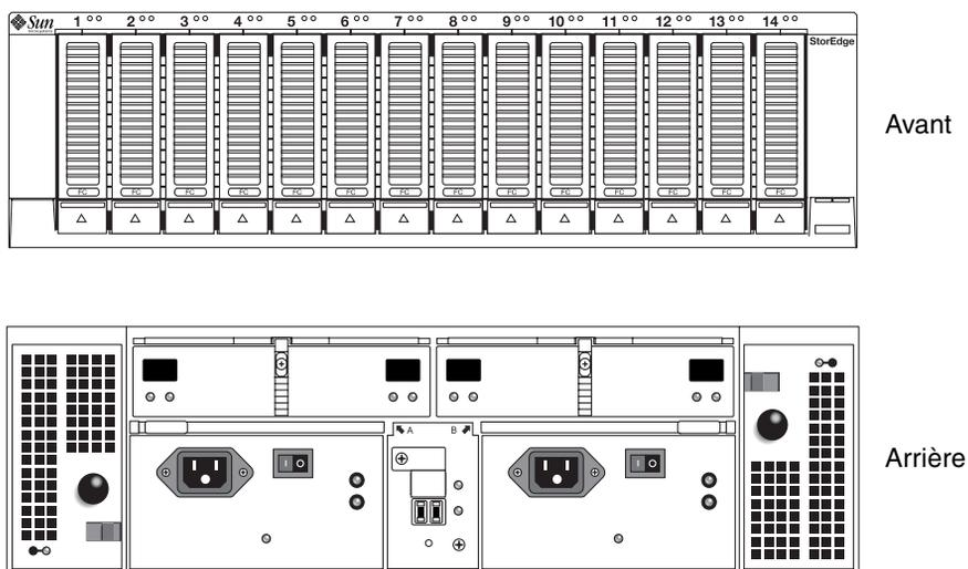
**FIGURE 1-4** Module d'extension (vues avant et arrière)
