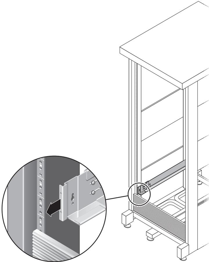
**FIGURE 2-10** Réglage de la longueur du rail droit à l'arrière du coffret
