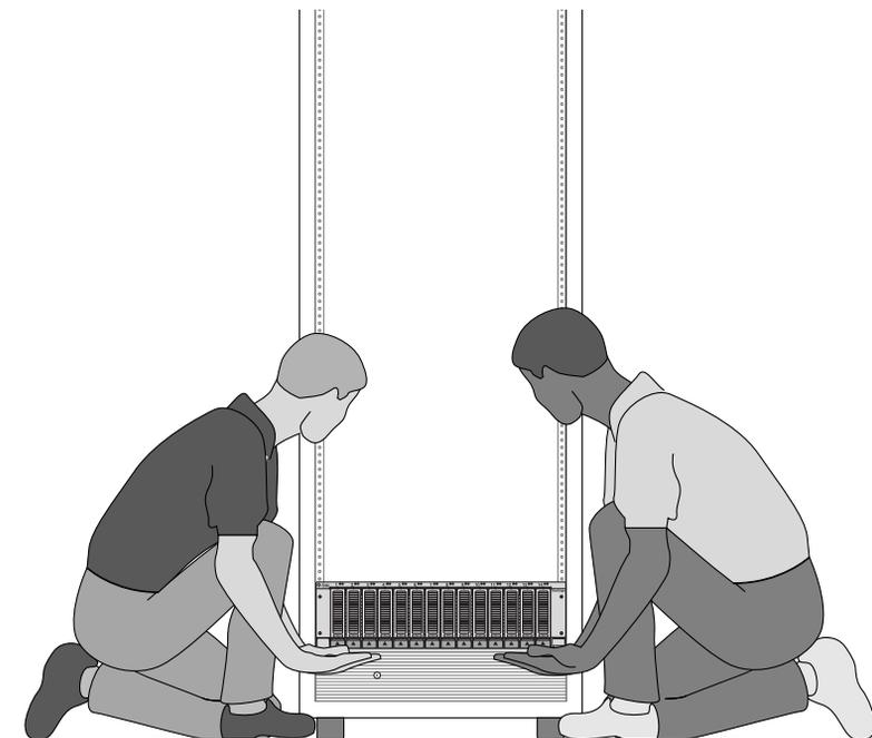
**FIGURE 2-14** Mise en place du module de baie dans le coffret
