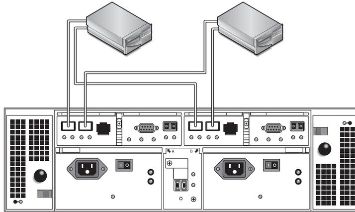
FIGURE 4-5 Connexion directe à deux hôtes avec deux HBA
