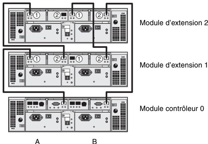
FIGURE 2-22 Interconnexion des câbles d'une configuration de baies 1x3
