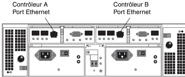
FIGURE 4-1 Ports Ethernet des contrôleurs A et B
