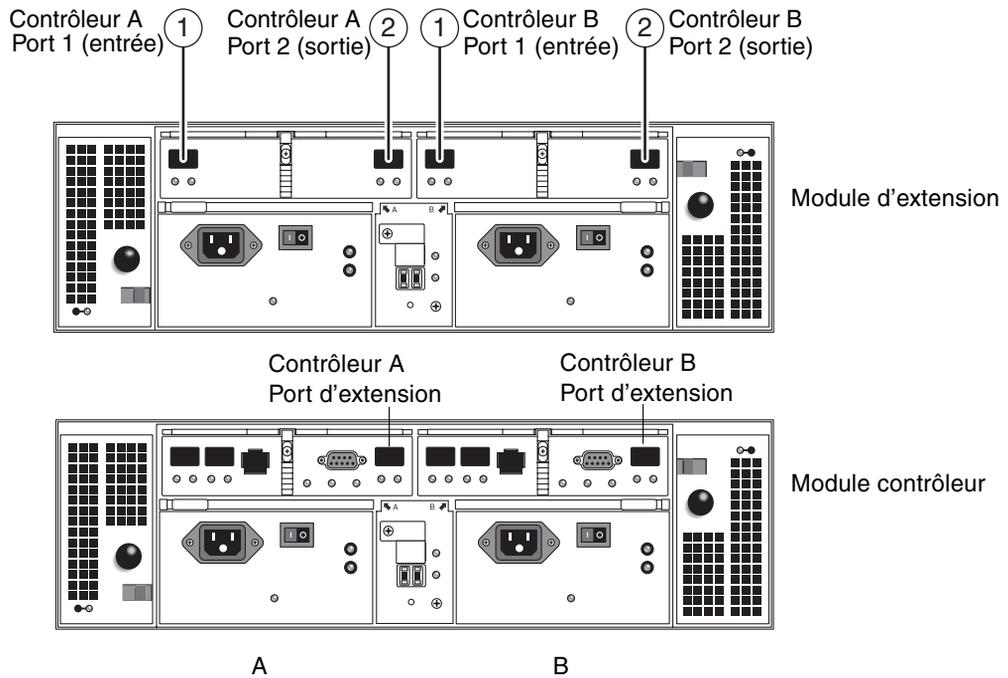
FIGURE 2-20 Ports des modules contrôleurs et d'extension
