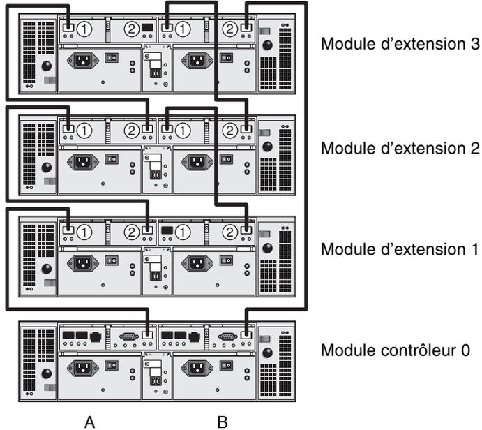
FIGURE 2-23 Interconnexion des câbles d'une configuration de baies 1x4
