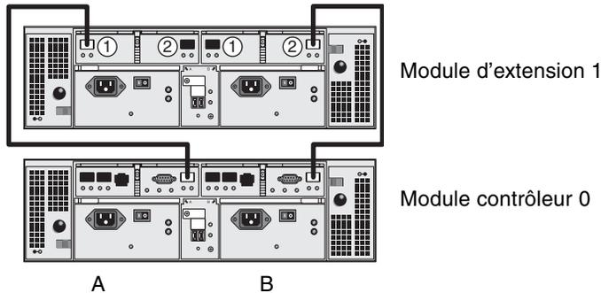
**FIGURE 2-21** Interconnexion des câbles d'une configuration de baies 1x2
