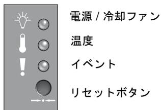
図 6-2 前面パネル上のシャーシイヤー LED とリセットボタン
