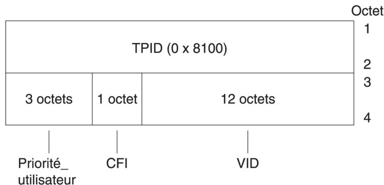
**FIGURE 2-1** Format de l'en-tête de la trame Ethernet
