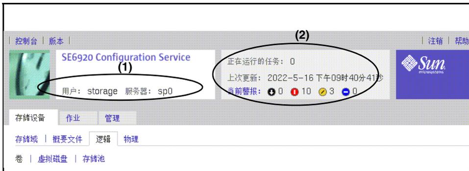
图 3-5 浏览 GUI: 快速状态显示
