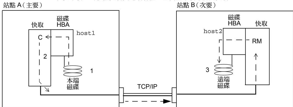
圖 2-1 完全同步化（容體對容體複製）
