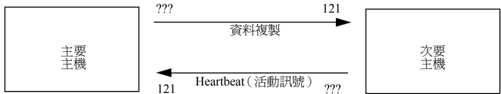
圖 1-2 Remote Mirror 軟體使用的 TCP/IP 連接埠位址
