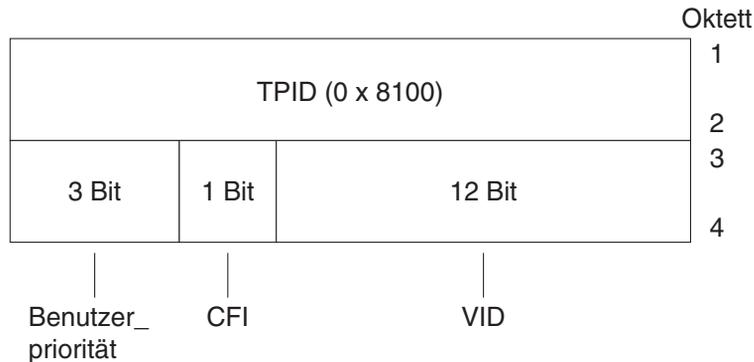
**ABBILDUNG 3-1** Ethernet Tag Header Format
