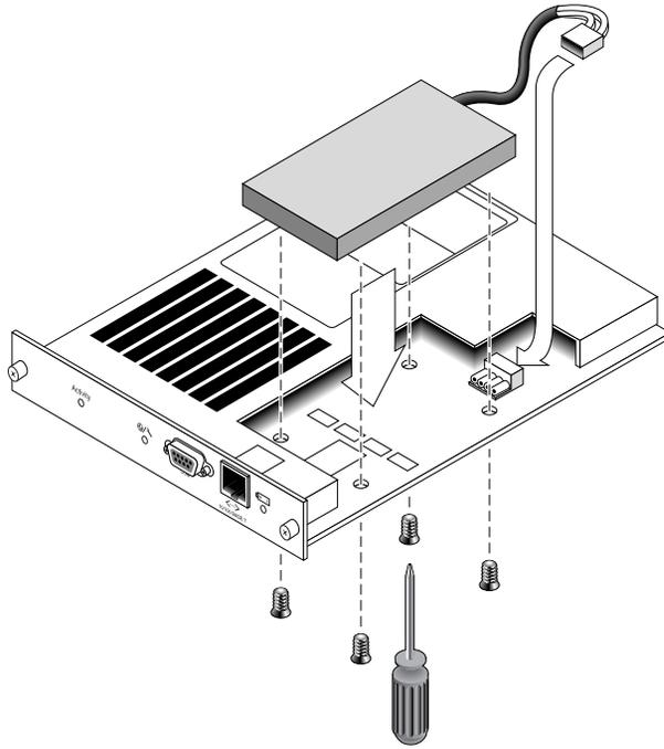
그림 4-7 배터리가 삽입된 제어기 모듈의 윗면 및 측면
