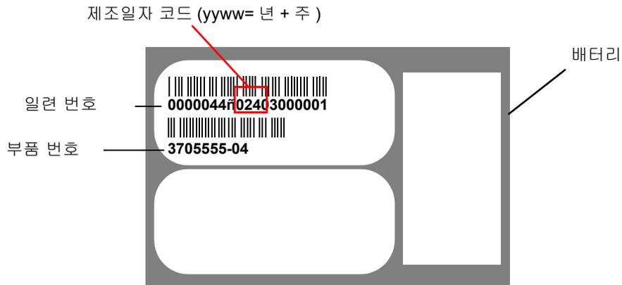
그림 4-1 Sun StorEdge 3310 SCSI 어레이에 대한 배터리 레이블 예
