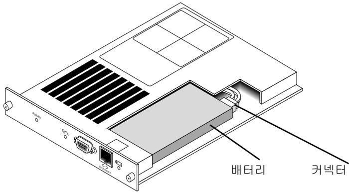
그림 4-3 SCSI 어레이 안의 배터리 및 커넥터
