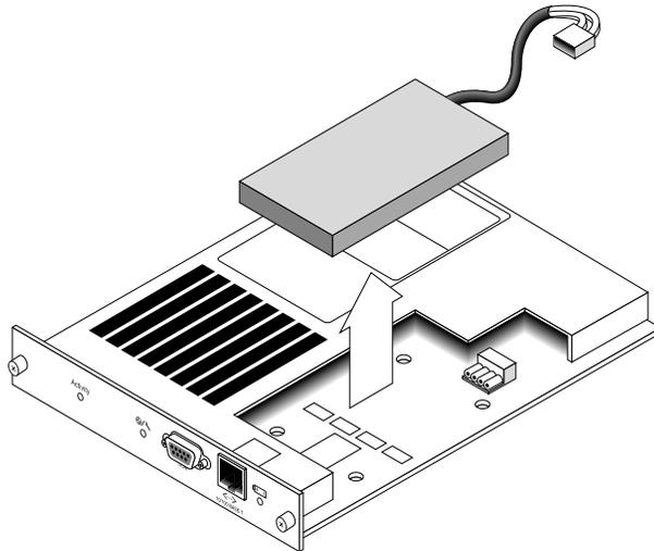
그림 4-6 커넥터 플러그를 뽑고 배터리를 들어 올린 제어기 모듈의 윗면
