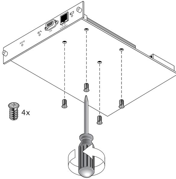
그림 4-5 나사를 제거한 배터리 모듈의 밑면
