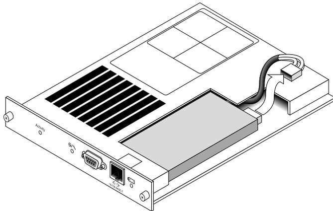
그림 4-4 SCSI 어레이 안의 플러그를 뽑은 배터리 커넥터
