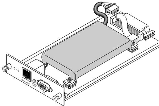
**그림 4-9** 배터리 모듈에서 분리된 배터리 커넥터
