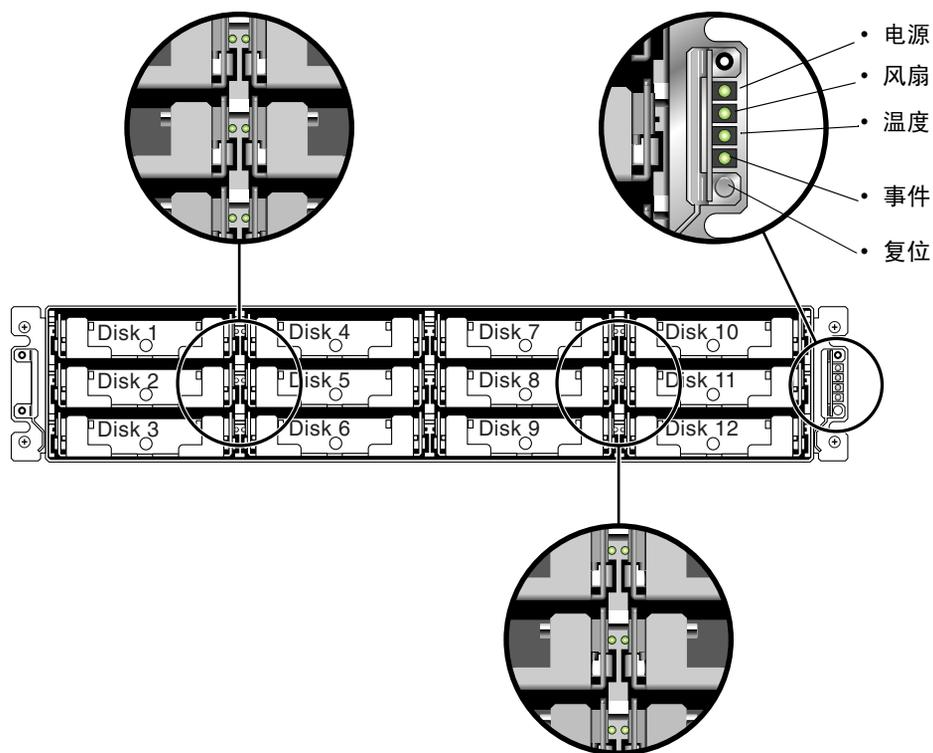
图 4-1 显示 LED 指示灯所在的前面板
