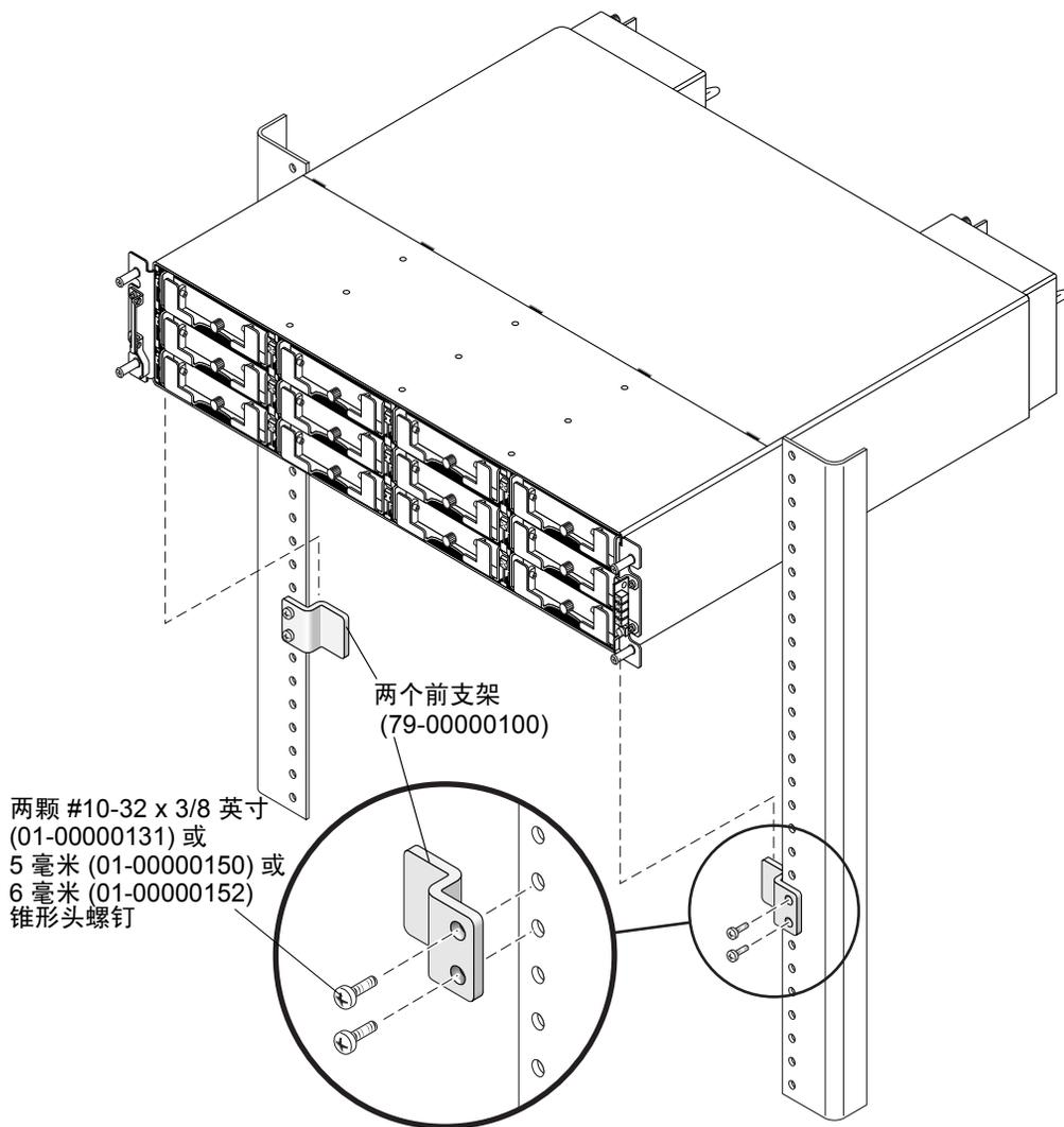
图 2-3 机架前面板上的前支架部分
