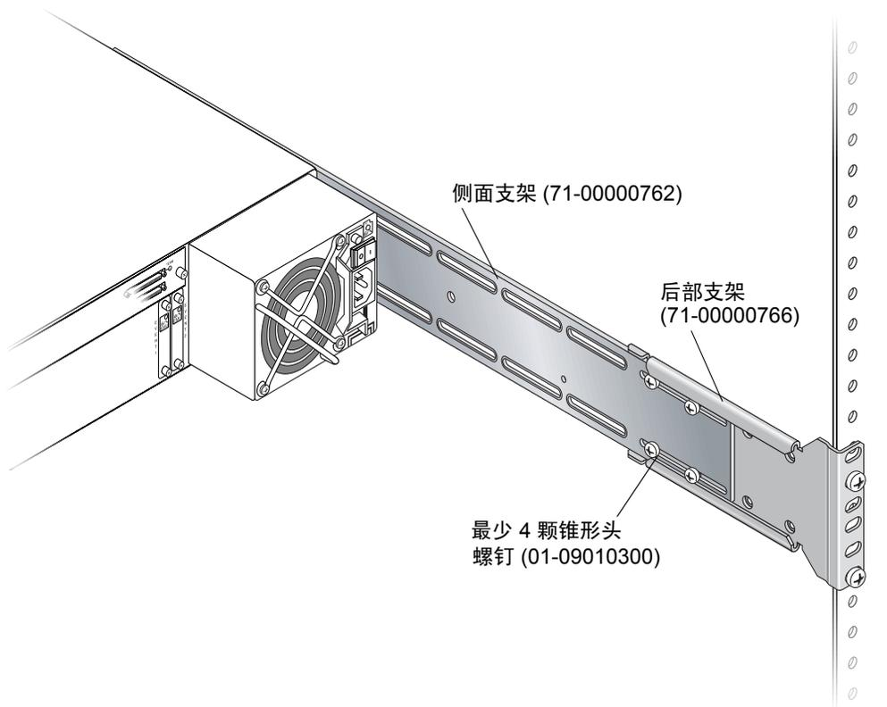
图 2-7 已组装好的后部和侧面支架
