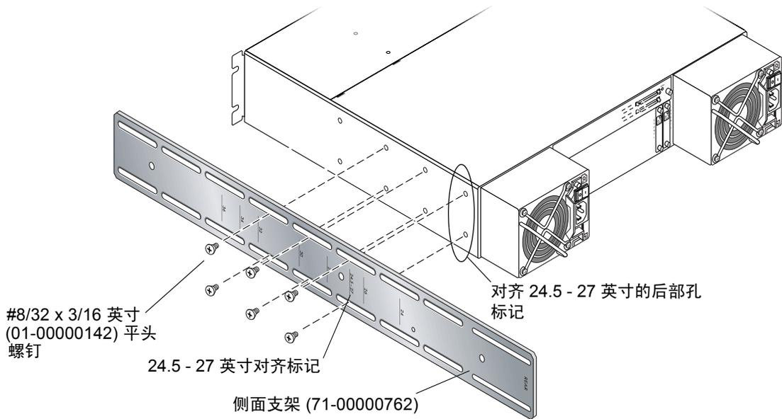
图 2-11 将侧面支架与阵列侧面上的后部螺纹孔对齐
