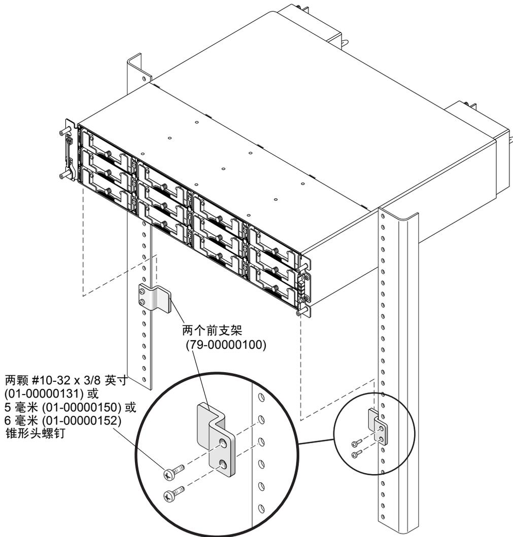
图 2-8 机架前面板上的前支架位置
