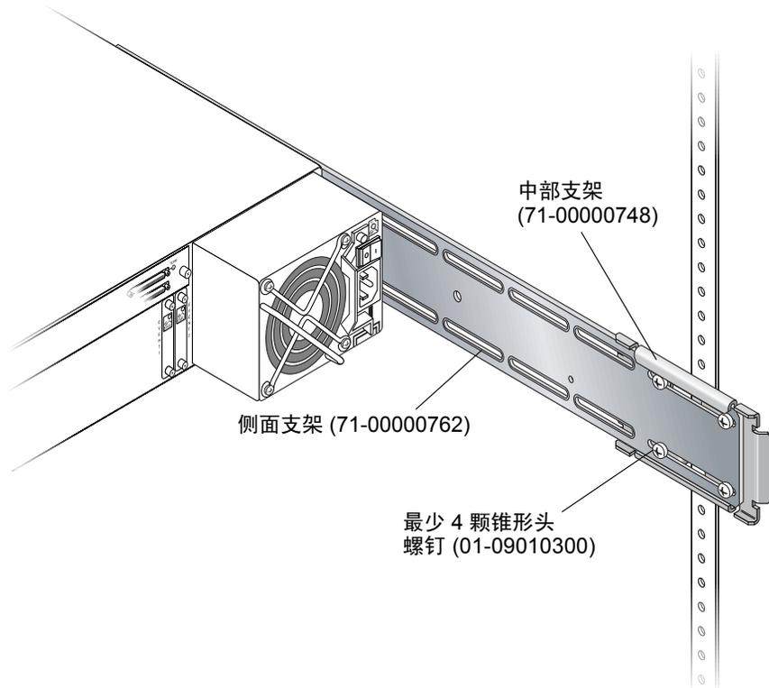
图 2-12 已组装好的中部和侧面支架
