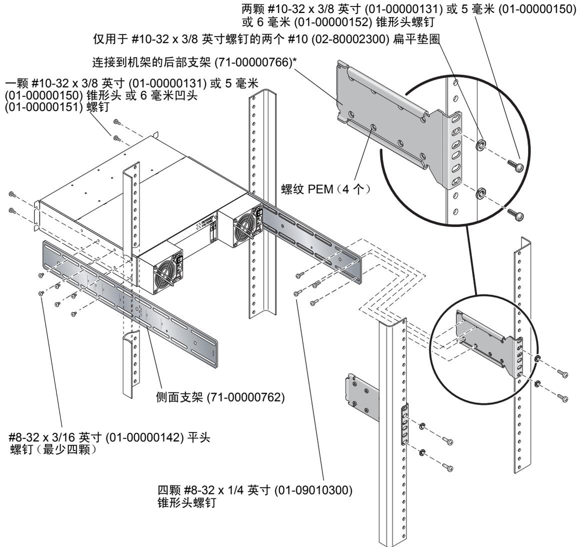
图 2-4 机柜后支架的机架安装
