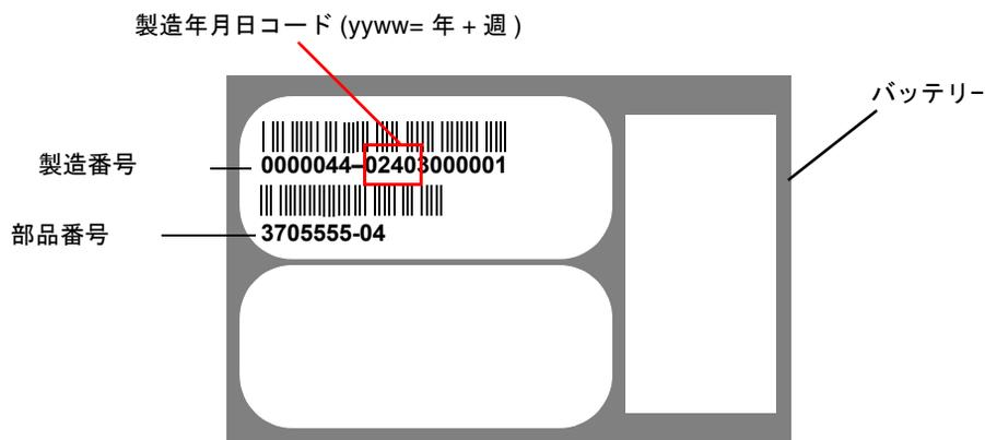
図 4-1 Sun StorEdge 3310 SCSI アレイのバッテリーラベルの例
