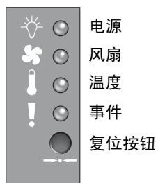
图 7-2 前面板上的机箱把手 LED 指示灯和复位按钮
