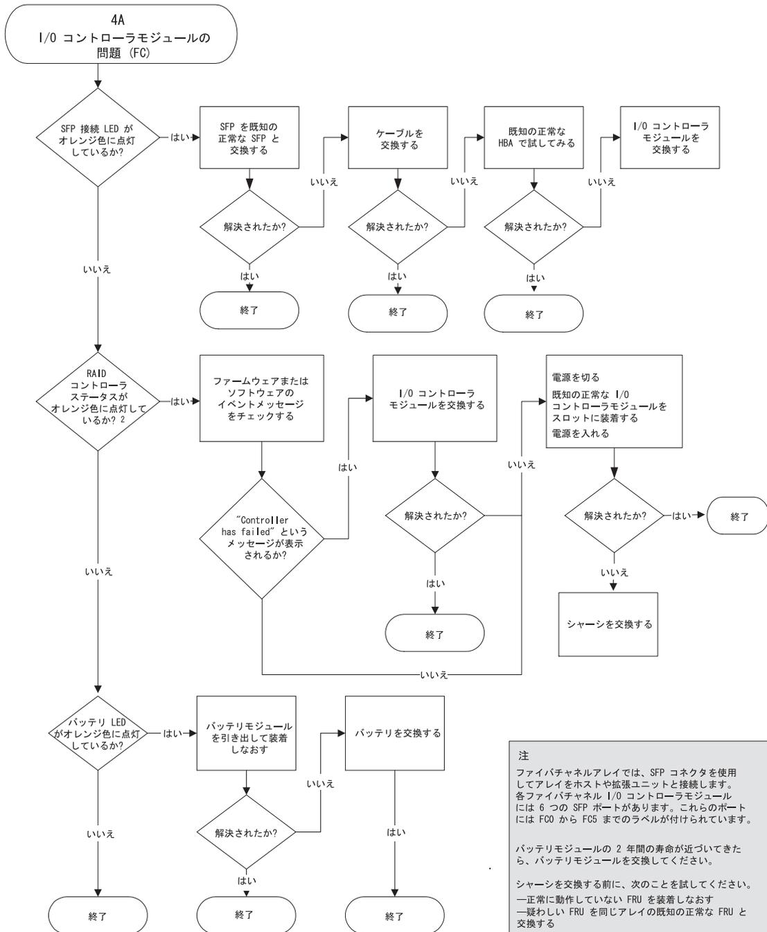
図 9-14 I/O コントローラモジュールのフローチャート
