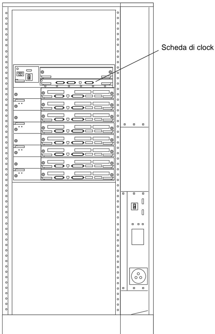
**FIGURA 6-2** Vista posteriore del sistema Sun Enterprise 6000
