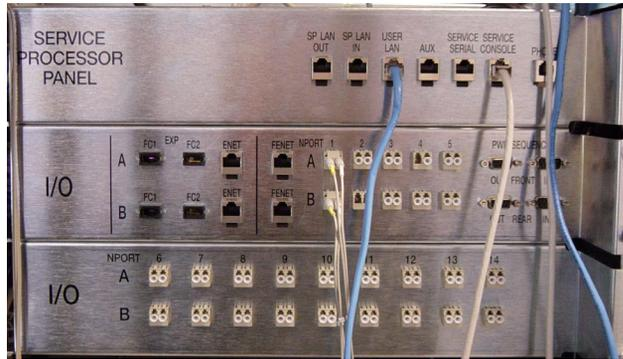
服务处理器面板用于简化系统布线。您只需将电缆连接至面板上的相应接口，而不必将电缆连接至系统中的各个组件。
