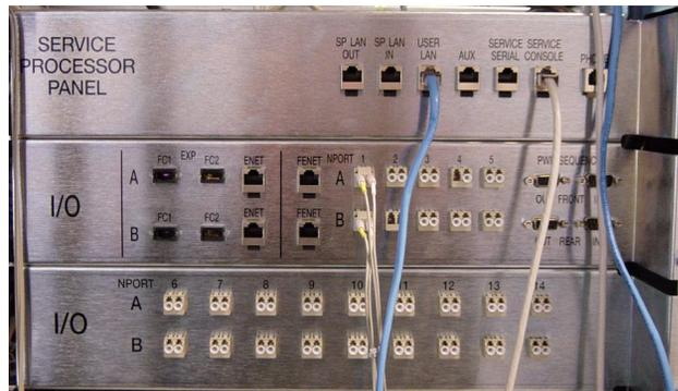
Le panneau du processeur de service simplifie les connexions au système. Vous pouvez connecter les câbles à ce panneau accessible plutôt qu'à chaque composant du système.
