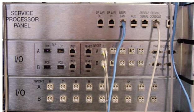
伺服處理器面板可簡化系統佈線程序。您可將纜線連接至這些可存取面板連接，而不是連接至系統的個別元件。
