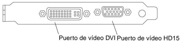
FIGURA 1-2 Puertos de E/S del panel posterior del acelerador de gráficos Sun XVR-100
