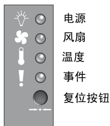
图 6-2 机箱把手 LED 指示灯和前面板上的复位按钮
