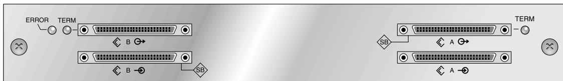
図 6-8 拡張ユニット用 I/O モジュール
