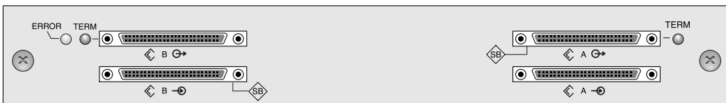
FIGURE 4-20 Configuration double bus d'une unité d'expansion
