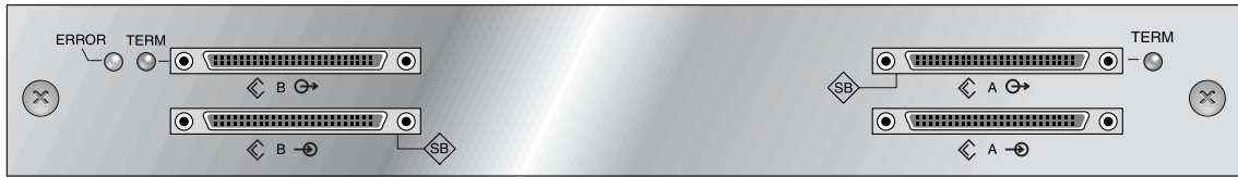
FIGURE 6-8 Module d'E/S pour une unité d'expansion
