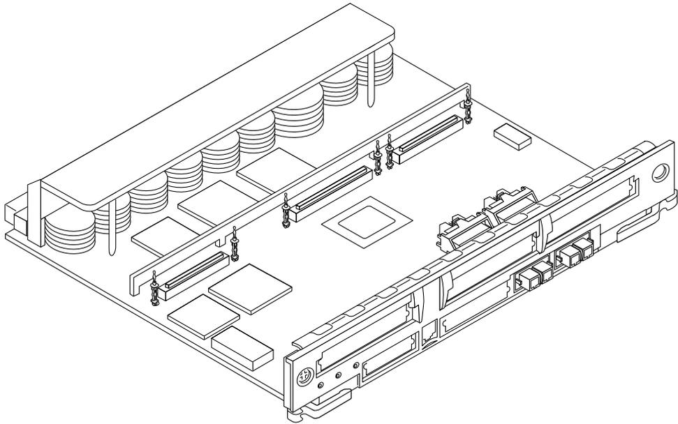
圖 11-1 Sun Enterprise 6x00/5x00/4x00/3x00 SBus+ I/O 板
