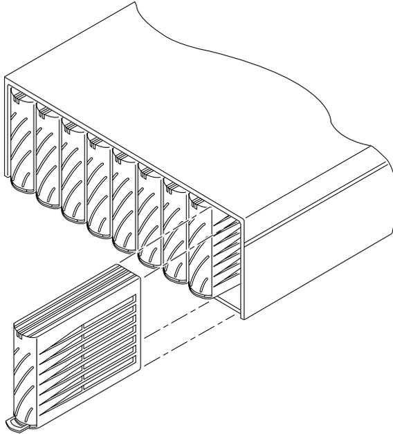
圖 14-4 移除磁碟機
