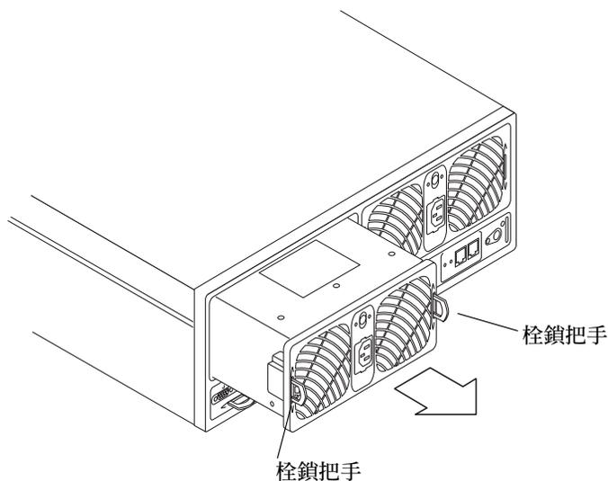
圖 14-6 移除電源與冷卻單元
