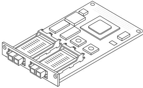
圖 11-3 Sun StorEdge SBus FC-100 主機匯流排配接卡
