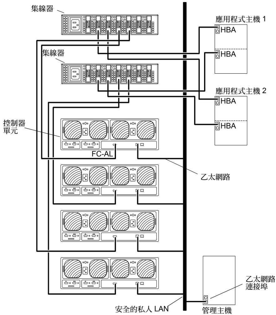
圖 4-8 配有兩個集線器和四個控制單元的雙主機
