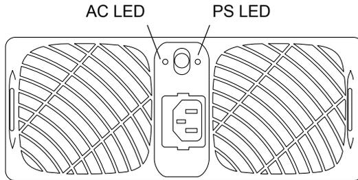
圖 13-2 電源與冷卻單元 LED
