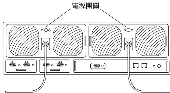
圖 14-5 連到電源與冷卻單元的電源線
