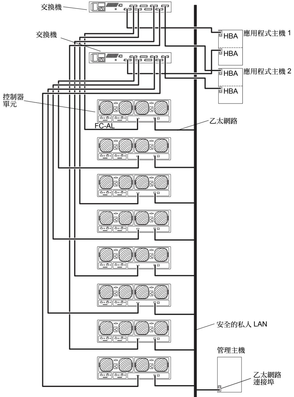
圖 4-13 配有兩個交換機和八個控制單元的雙主機
