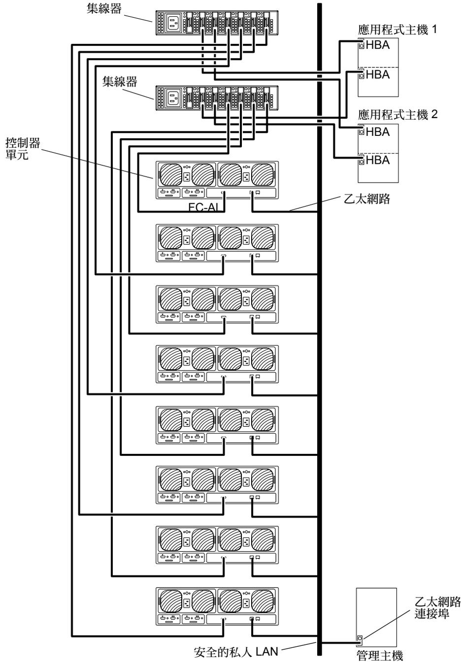
圖 4-9 配有兩個集線器和八個控制單元的雙主機
