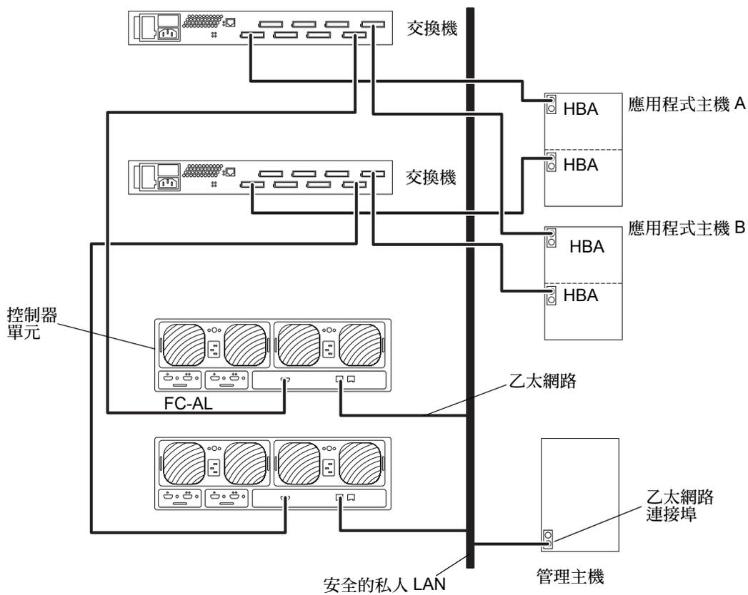
圖 4-12 配有兩個交換機和兩個控制單元的雙主機
