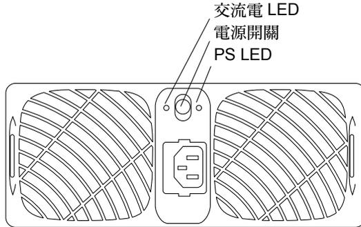
圖 6-7 電源與冷卻單元 LED 與電源開關的位置
