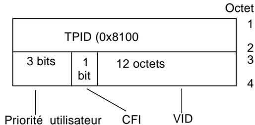
FIGURE 3-1 Format de l'en-tête de la trame Ethernet
