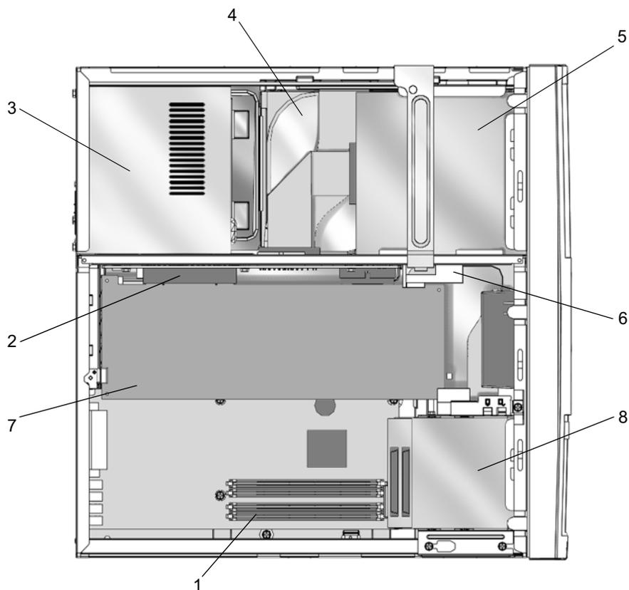
**FIGURA 4-5** Disposición interna de la estación de trabajo (vista superior sin la cubierta)
