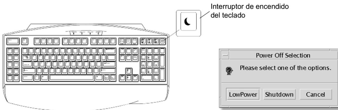
**FIGURA 2-2** Interruptor de encendido del teclado Sun USB tipo 6 y cuadro de diálogo Power Off Selection (Selección de apagado)
