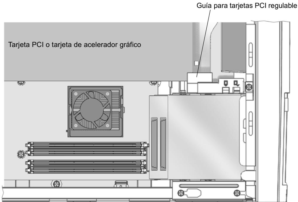
FIGURA 4-9 Guía para tarjetas PCI
