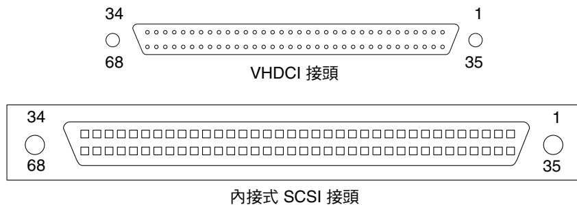
圖 B-1 VHDCI 與內接式 SCSI 接頭
