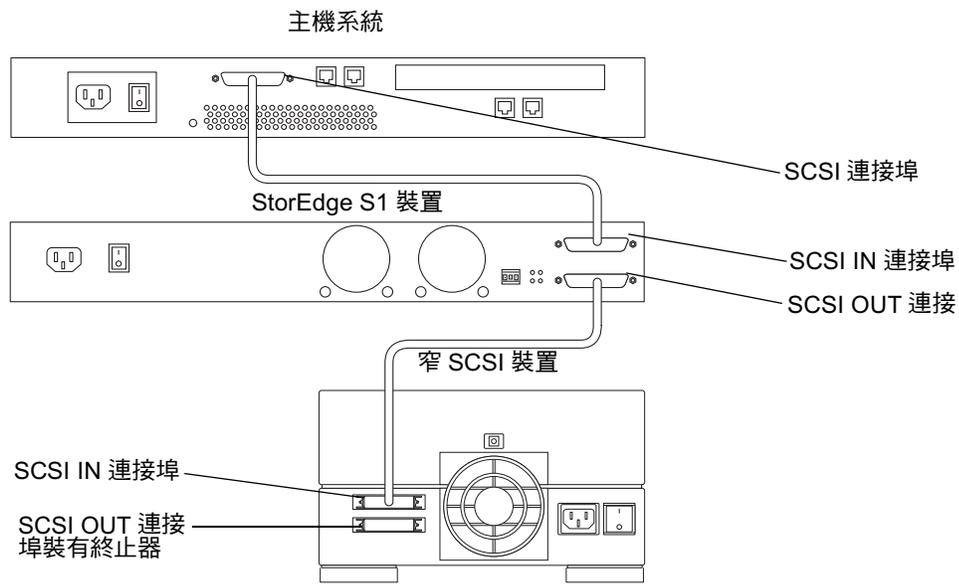
圖 3-20 以菊花链方式串接 StorEdge S1 儲存裝置與窄 SCSI 裝置
