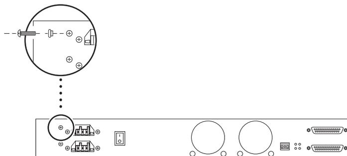
圖 3-26 固定基座接地連線螺絲
