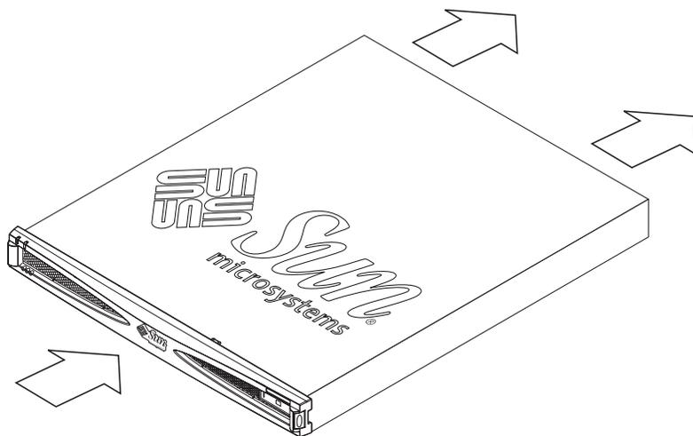
圖 1-12 氣流需求（前端和後端）
