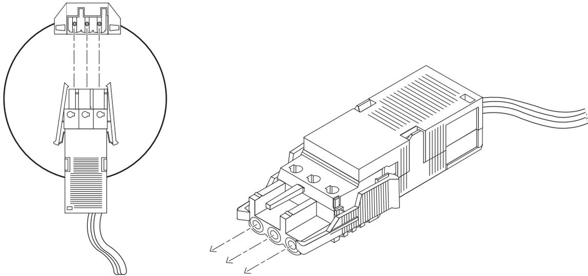
圖 3-23 將 DC 輸入電源線連接到 DC 接頭
