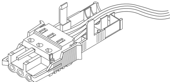
圖 2-10 將電線由電線收存器的底部拉出
