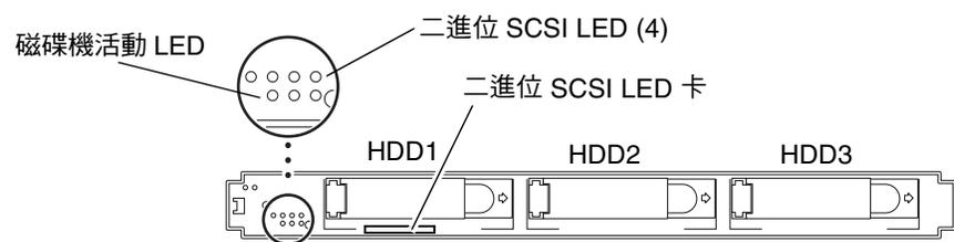
圖 1-3 StorEdge S1 儲存裝置正面圖 (Bezel 已移除)
