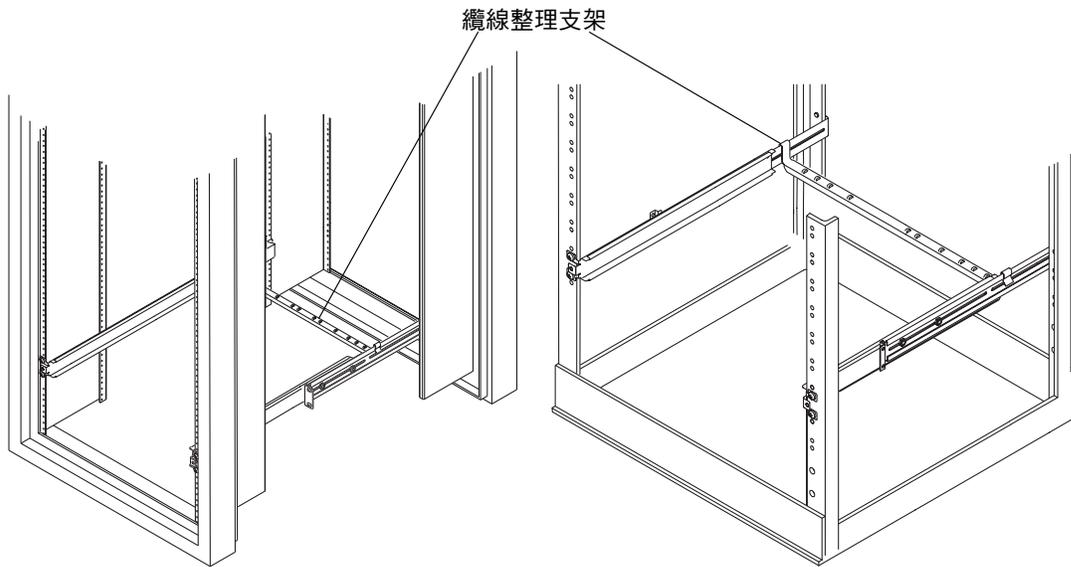
圖 3-8 纜線整理支架已安裝在兩個活動機架上
