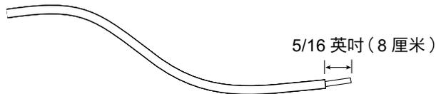
圖 2-5 剝除電線絕緣皮
