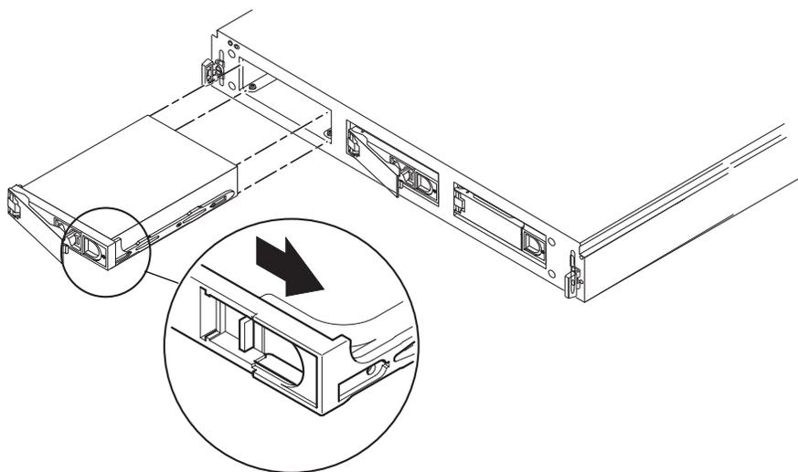
圖 4-3 移除與更換磁碟機
