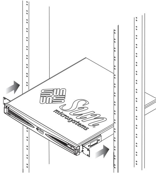
圖 3-11 將托架往前安裝到兩腳繼電機架中
