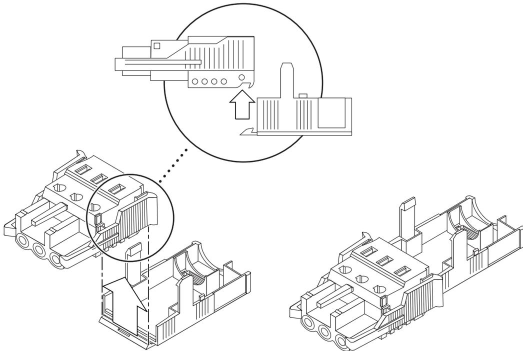
圖 2-9 將電線收存器的底部插入
