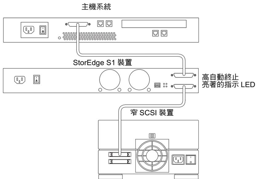
圖 5-6 窄 SCSI 菊鍊中的自動終止指示 LED
