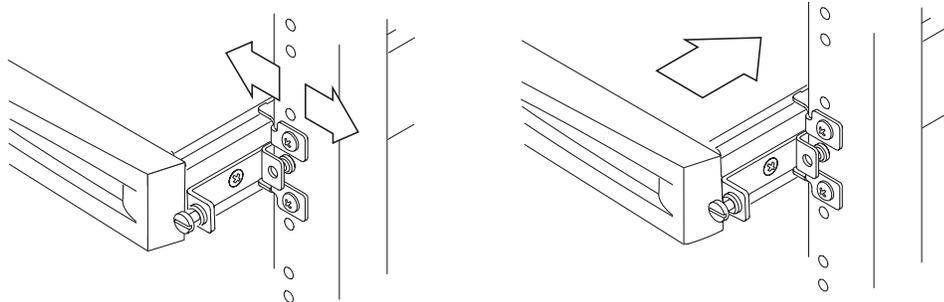
圖 3-6 調整裝配組件並鎖緊指捻螺釘
