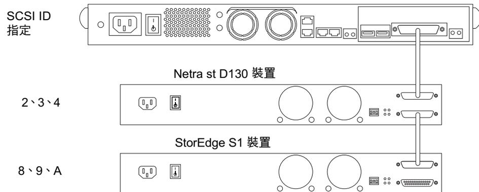
圖 3-18 含有 LVD SCSI 的主機系統上一個 StorEdge S1 裝置與一個 Netra st D130 裝置（範例）
