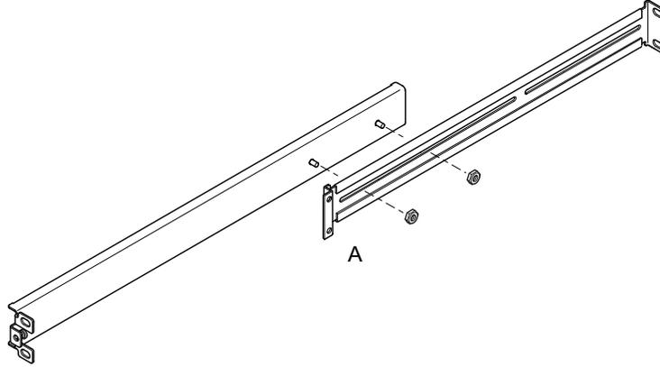
圖 3-1 標準 19 英寸活動機架的滑動裝配組件
