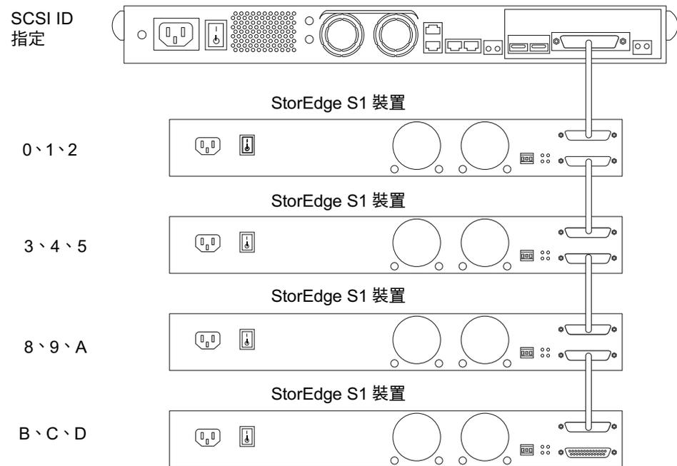
圖 3-17 含有 LVD SCSI 的主機系統上四個 StorEdge S1 裝置（範例）
