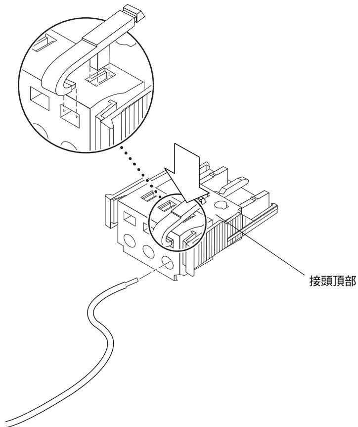
圖 2-6 使用機箱夾鉗操作桿開啓 DC 接頭機箱夾鉗
