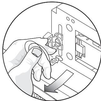
圖 5-11 將鎖頭整個從底座拉出
