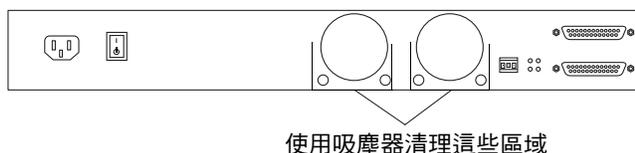
圖 5-13 清理後端風扇隔板
