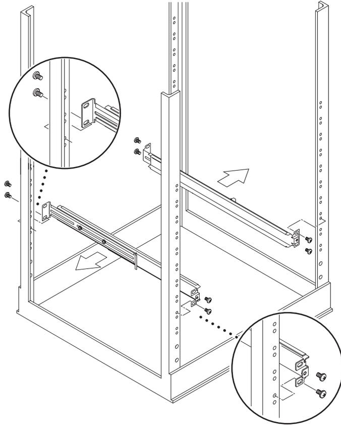
圖 3-3 將滑動裝配組件鎖到標準 19 英寸機架上
