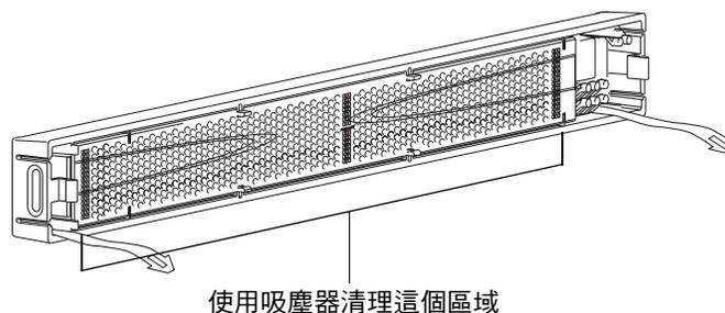
圖 5-12 清理前端 Bezel 隔板
