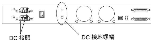
圖 3-22 連接 DC 接地線
