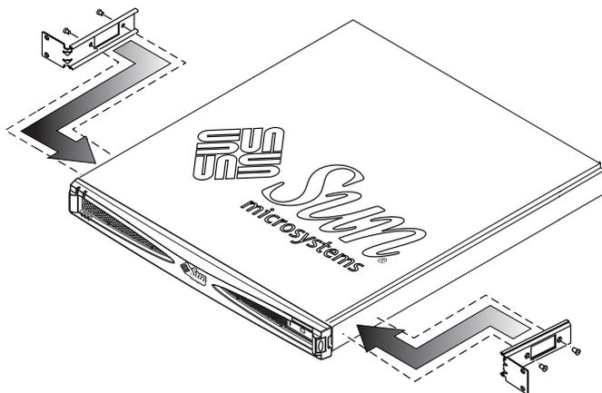
圖 3-9 將架裝托架接在前方
