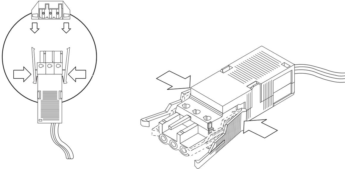
圖 3-24 從 DC 接頭拔下 DC 輸入電源線
