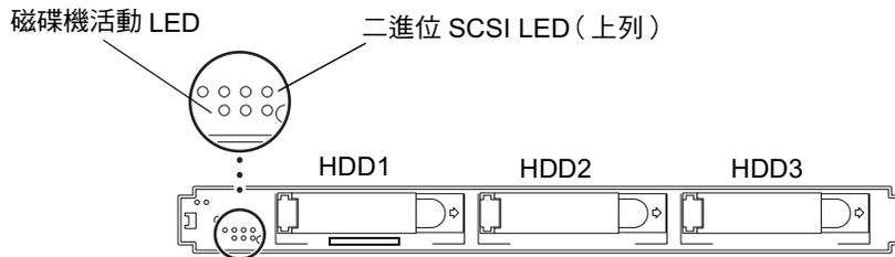
圖 5-2 前面板 LED，Bezel 已移除
