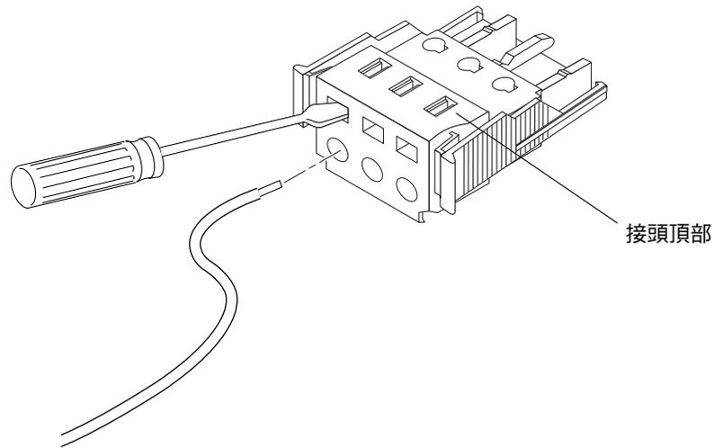
圖 2-7 使用螺絲起子開啓 DC 接頭機箱夾鉗
