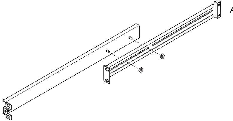
圖 3-2 Sun 72 英寸活動機架的滑動裝配組件
