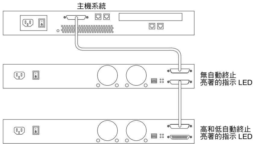
圖 5-5 UltraSCSI 或寬 SCSI 菊鍊的自動終止指示 LED
