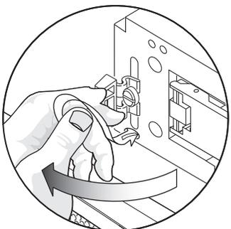
圖 5-9 將門鎖推入到一邊，使鎖頭露出一部分
