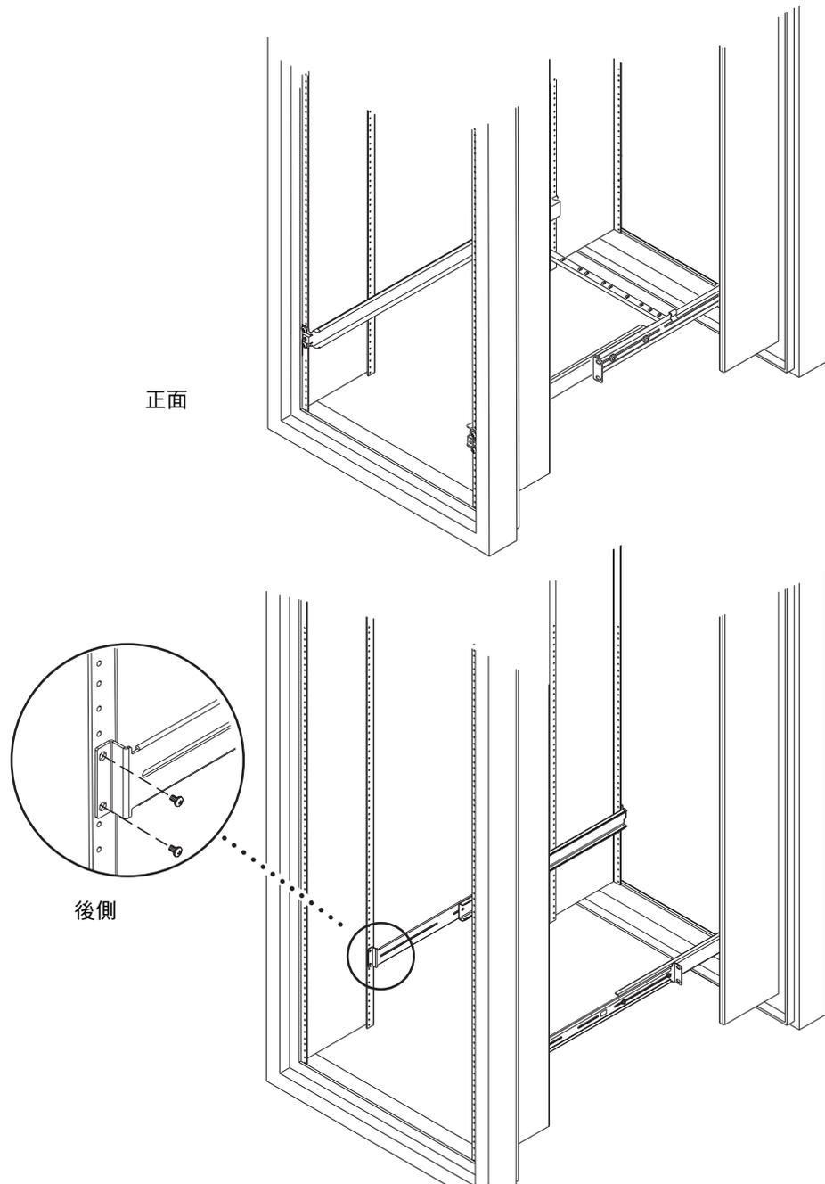
圖 3-4 將滑動裝配組件鎖到 Sun StorEdge 72 英吋高機架上 — 正面與後側圖
