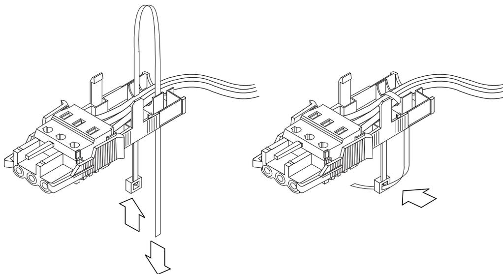
圖 2-11 將電線固定在電線收存器上
