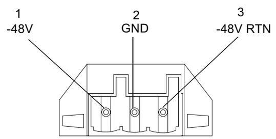
圖 2-4 DC 電源供應器上的 DC 接頭
