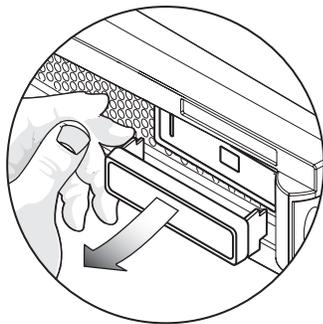
圖 1-5 從 Bezel 拉出右側的固定柄
