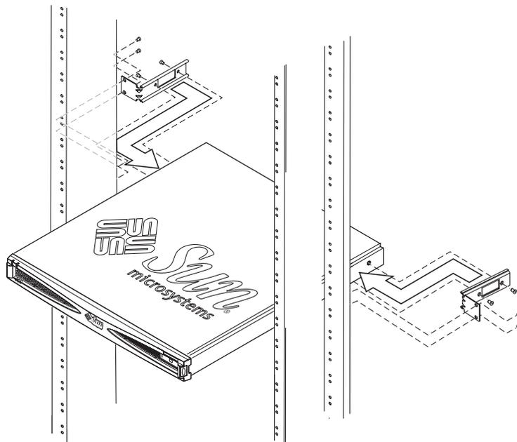
圖 3-12 將托架往後安裝到兩腳繼電機架中
