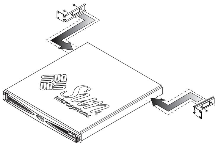
圖 3-10 將架裝托架接在後側
