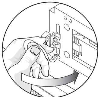
圖 5-10 將門鎖推入到相反的方向
