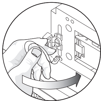
图 5-10 向相反方向推固定带
