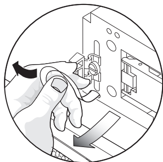
图 5-8 拉其中一个固定带，直到固定带的头阻止其从机箱的孔中脱出
