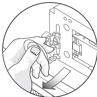
图 5-11 将固定带的头从机箱中完全拉出
