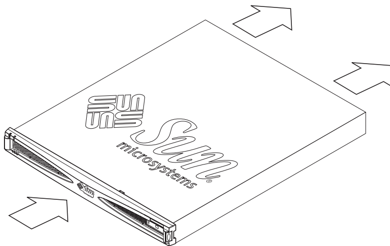
BILD 1-12 Luftflödeskrav (fram- och baksida)
