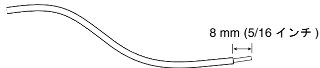
図 2-5 ワイヤーの絶縁材の剥ぎ取り
