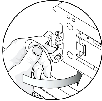
図 5-10 つなぎ具を反対の方向に押した状態
