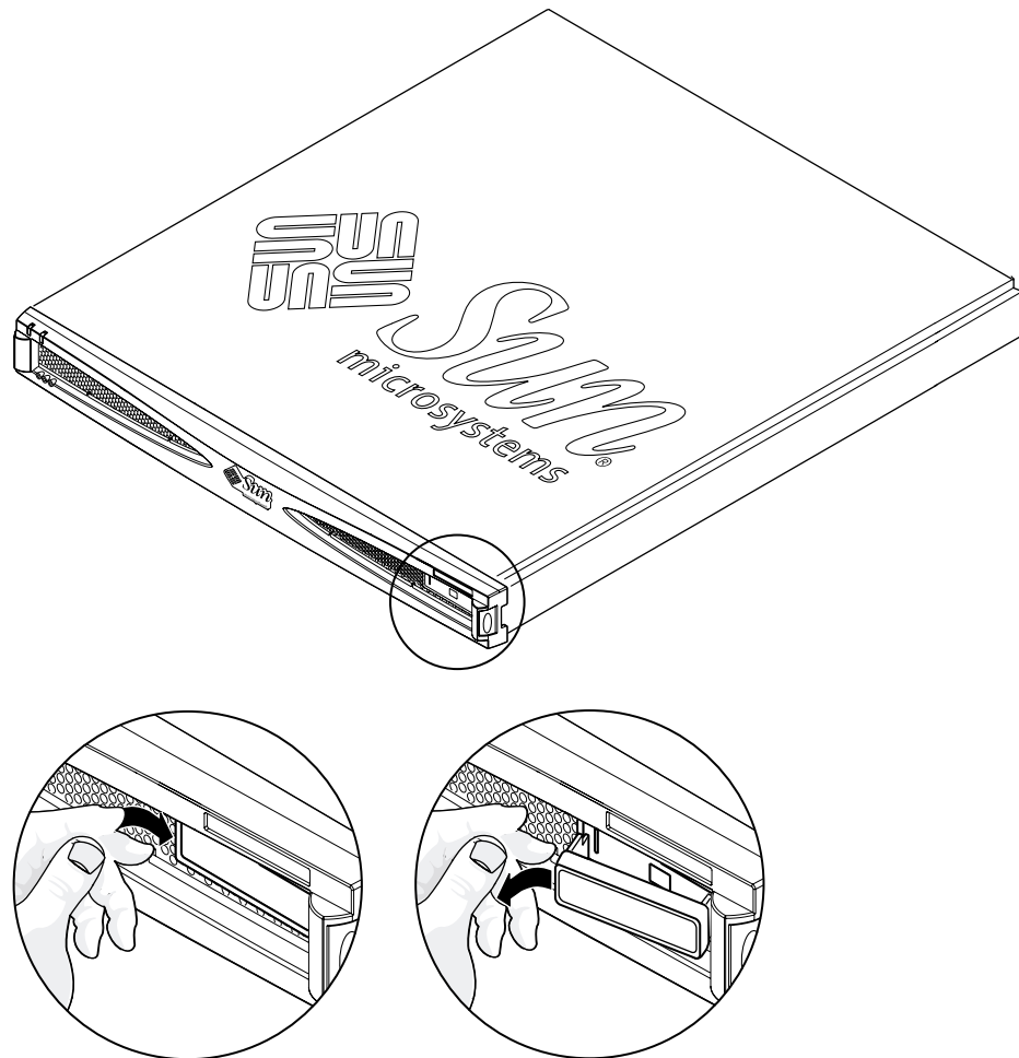
図 1-4 左側を固定する突起が外れ、ネームプレートの左側が飛び出た状態
