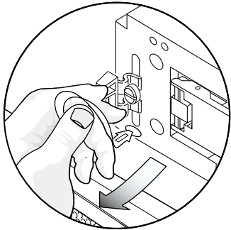
図 5-11 つなぎ具を引いて、先端部分をシャーシの穴から完全に取り出した状態
