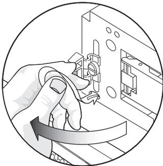
**FIGURE 5-9** Déplacement de l'attache sur un côté de manière à dégager partiellement son embout
