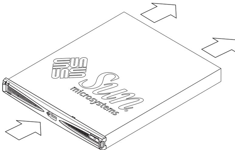
FIGURE 1-12 Conditions de la ventilation (avant et arrière)
