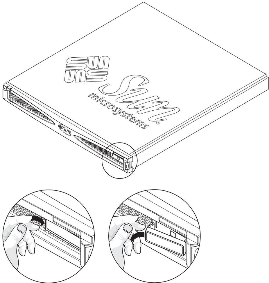
**FIGURE 1-4** Libération de la patte de fixation gauche pour dégager la plaque d'identification
