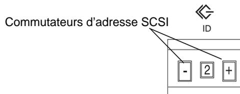
FIGURE 3-15 Commutateur d'adresse SCSI à l'arrière du système de stockage
