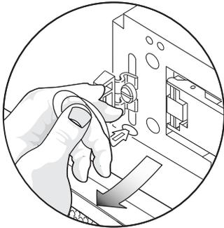
FIGURE 5-11 Dégagement complet de l'embout de l'attache hors du châssis
