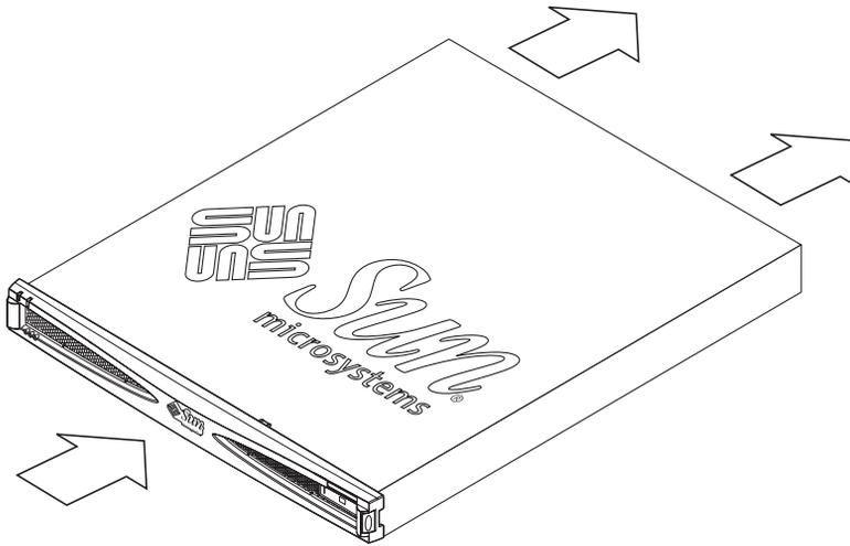
FIGURA 1-12 Requisitos de circulación del aire (partes frontal y posterior)
