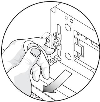
FIGURA 5-11 Tirar del cabezal del engarce sacándolo totalmente del chasis
