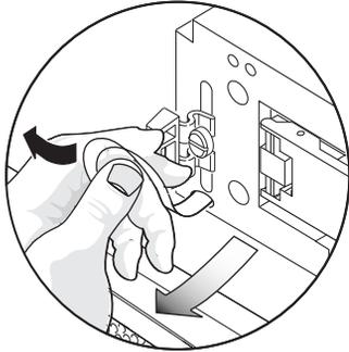
**FIGURA 5-8** Tirar de una de las ligaduras hasta que el cabezal haga tope y le impida salir
