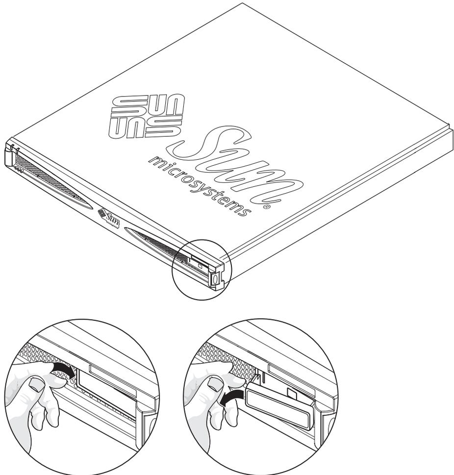
**FIGURA 1-4** Retirada de la lengüeta de retención izquierda para que la placa de identificación bascule hacia fuera
