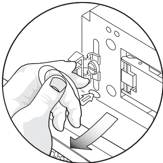
ABBILDUNG 5-11 Komplettes Herausziehen des Haltebandkopfes aus dem Chassis
