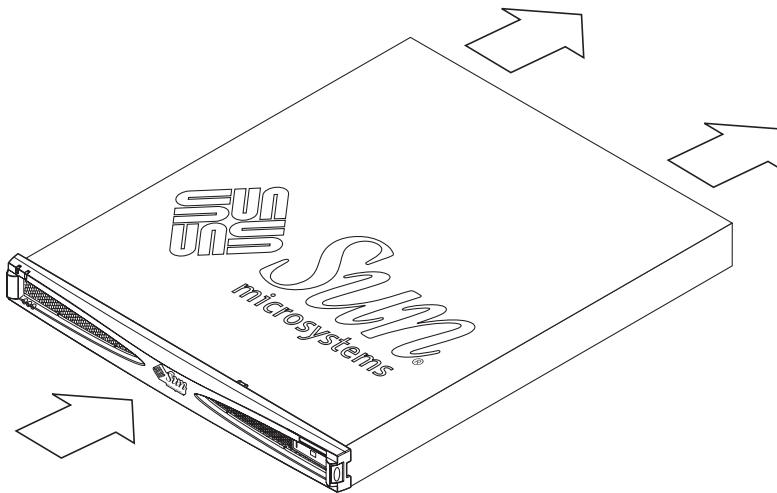
ABBILDUNG 1-12 Erforderliche Luftströmung (Vorder- und Rückseite)
