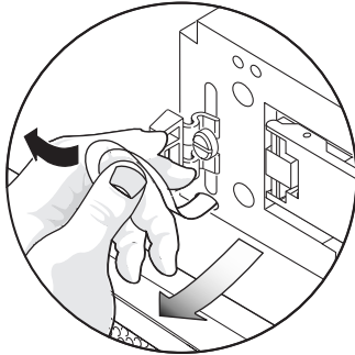
ABBILDUNG 5-8 Herausziehen des Haltebandes bis der Kopf die Öffnung erreicht
