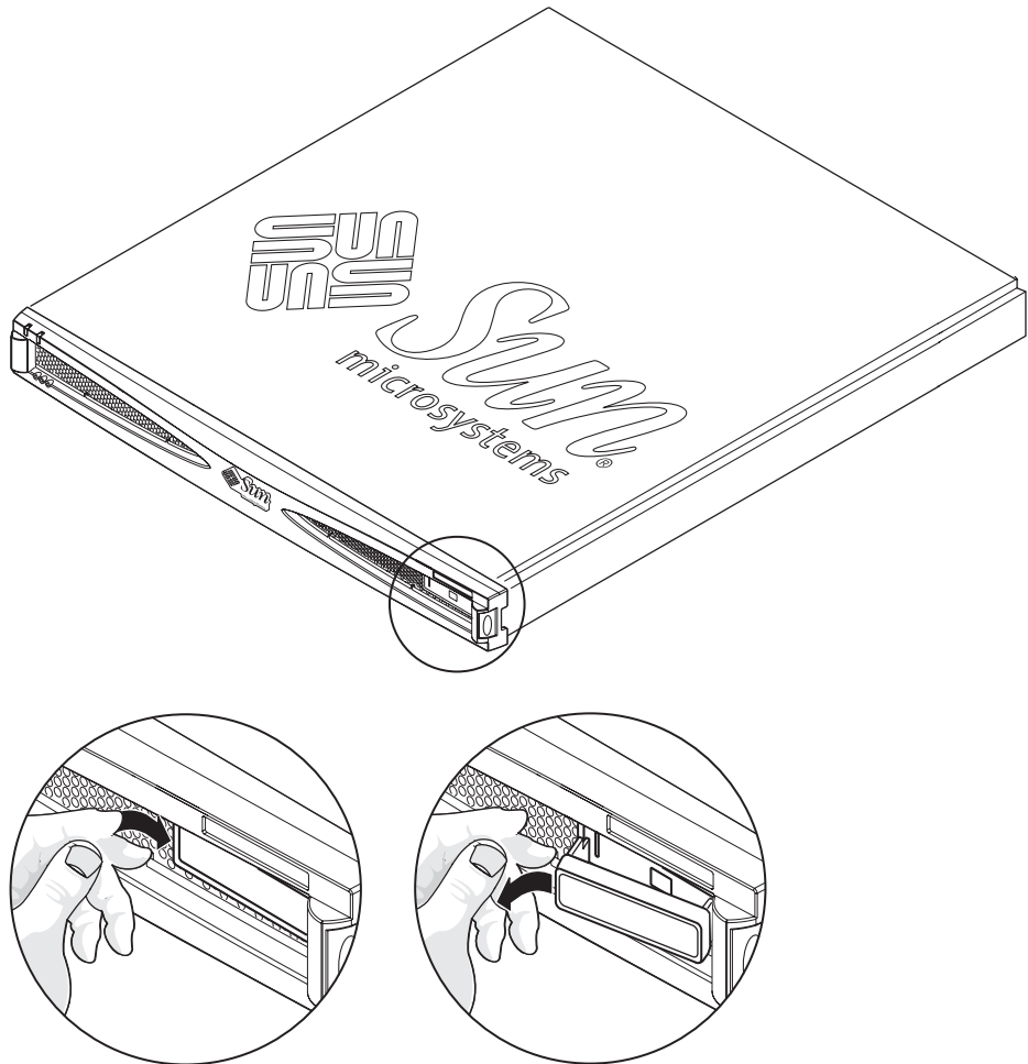
ABBILDUNG 1-4 Lösen der linken Halteklammer zur Freigabe des Typenschilds
