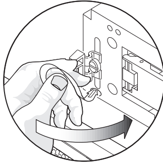
ABBILDUNG 5-10 Drücken des Haltebandes in die andere Richtung
