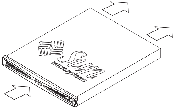
ABBILDUNG 1-13 Erforderliche Luftströmung (offenes Rack)
