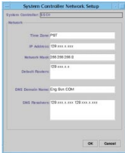
FIGURA 3-13 Finestra di dialogo Configurazione rete controller di sistema
