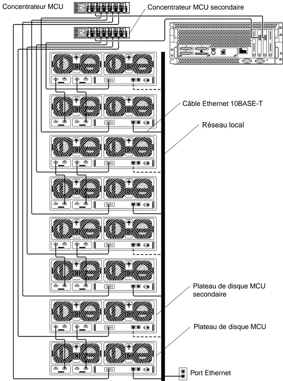
**FIGURE 1** Configuration maximale pour Sun StorEdge N8400 Filer
