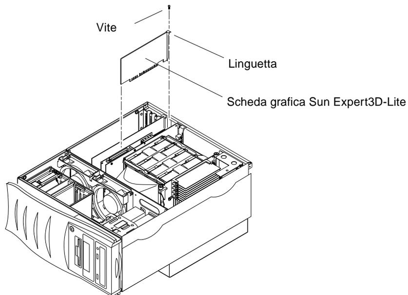
FIGURA 2-4 Installazione della scheda grafica Sun Expert3D-Lite in un sistema Ultra 80
